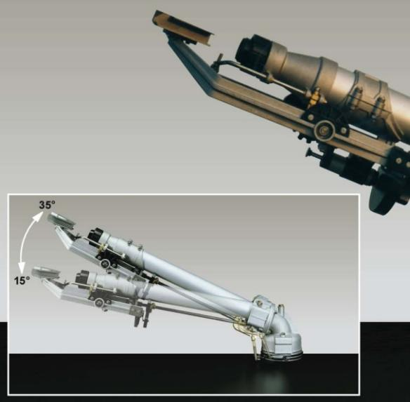
Irrigatore ad angolo variabile per alte portate, con funzionamento circolare o a settori, a ritorno lento. Costruito per irrigazione su macchine semoventi o per impianti mobili o fissi, è particolarmente indicato per irrigazione in zone a forte vento, in terreni percorsi da basse linee elettriche aeree e per fertirrigazione ecologica.
