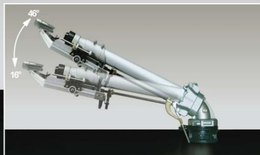
Irrigatore ad angolo variabile per medie ed alte portate, con funzionamento circolare o a settori, a ritorno lento. Costruito per irrigazione su macchine semoventi o per impianti mobili o fissi, è particolarmente indicato per irrigazione in zone a forte vento, in terreni percorsi da basse linee elettriche aeree e per fertirrigazione ecologica. Lavora senza problemi anche in terreni a forte pendenza.
